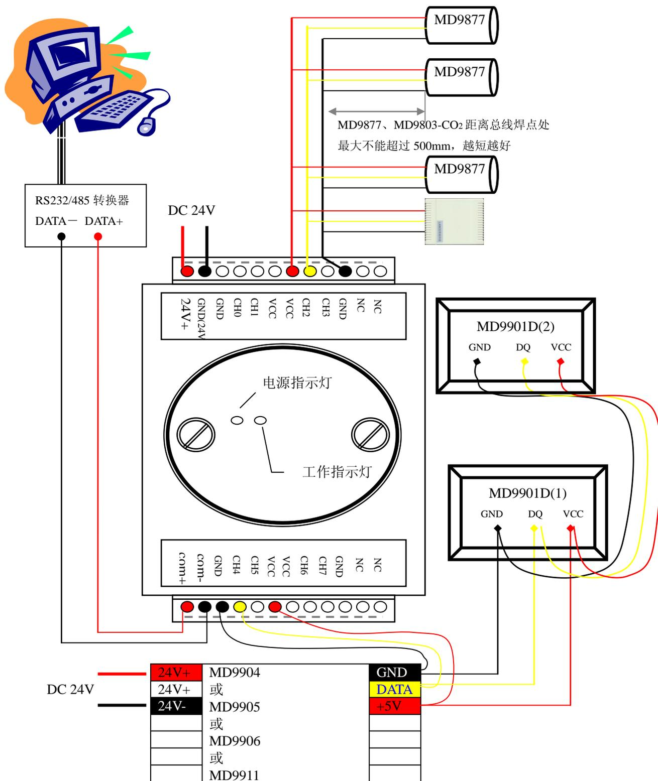
注：接线时注意将 1-wire 协议产品（包括 MD987X 温度探头和 MD9803-CO<sub>2</sub> 探头）和 ITU 协议产品（包括 MD990X 产品）连接到 MD9662 的不同通道即可，如图所示。
